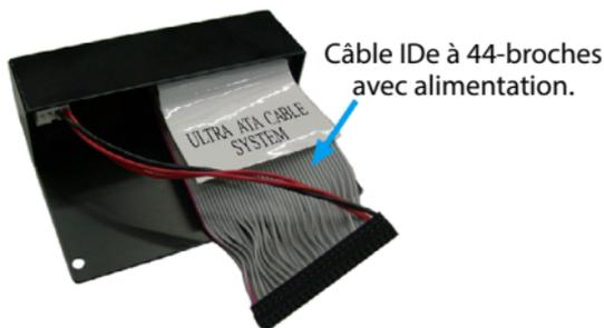
3. Connectez le disque dur IDE au connecteur (à 44-broches) sur le câble ruban.
