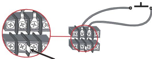
Per un'installazione che utilizzerà un contatto di commutazione e un'alimentazione esterna a 24 V di alimentazione, rimuovere il ponticello e collegare l'interruttore REPO con un'aletta del cavo e anello per l'alimentazione esterna.
