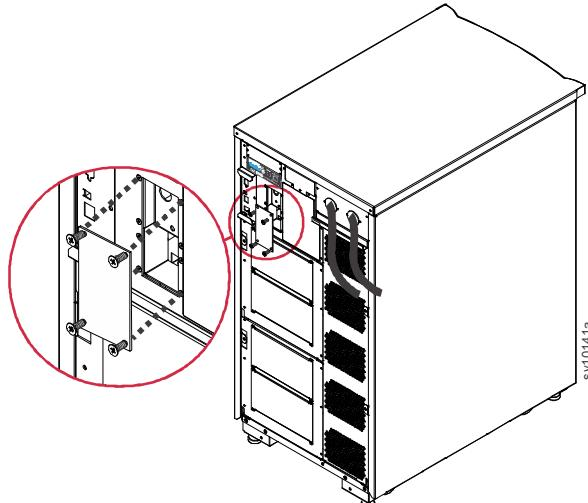
Per un'installazione che utilizzerà un esterno interruttore contatto, collegare l'interruttore REPO un ponticello esistente.
