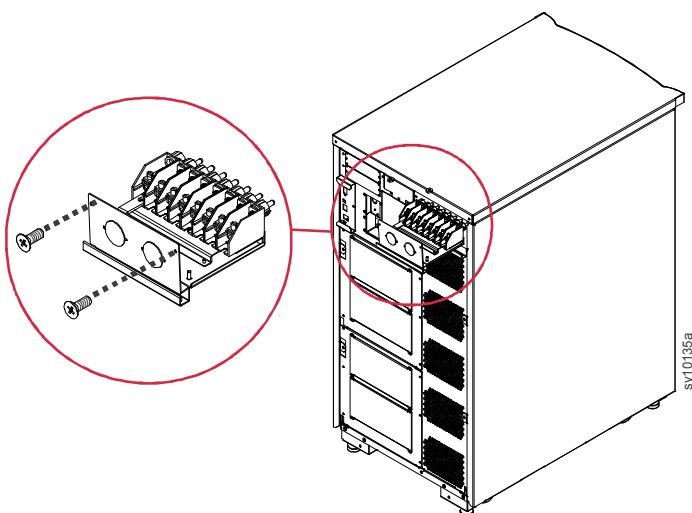
Inserire il condotto di dimensioni appropriate attraverso i fori di sollevamento del ceppo nel vassoio di AC.
