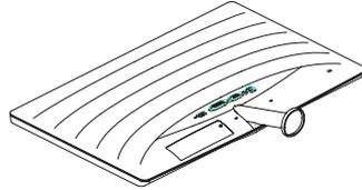
2. Tenez le support du socle avec deux mains et insérez fermement le support du socle dans la colonne du socle.
