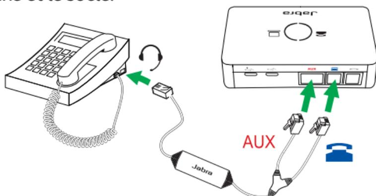
Pour des instructions spécifiques sur la connexion d'un adaptateur pour cordon de décroché automatique\* à un téléphone fixe, veuillez consulter la documentation sur le branchement des câbles fournie avec l'adaptateur.
