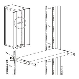
**Montage horizontal encastré.** Vous pouvez monter la PDU en rack en position encastrée; pour cela, fixez les supports aux autres emplacementss de la PDU comme indiqué ci-dessous.
