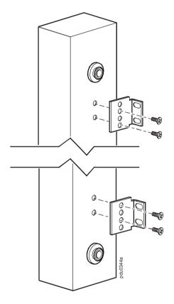
2. Fixez la PDU en rack sur le rail de montage vertical de l'armoire ou du rack à l'aide des vis et écrous cages fournis.
